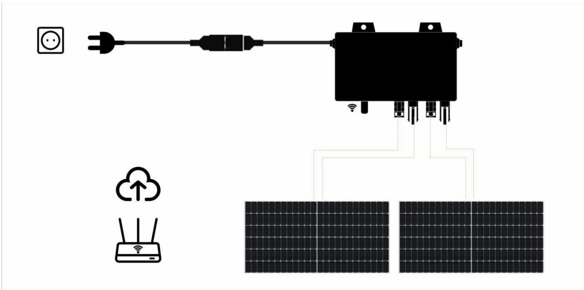
Bei der Balkonlösung gibt es nur einen Wechselrichter im System. Die Überwachung erfolgt über eine WLAN-Verbindung zwischen WLAN-Dongle am Wechselrichter und Heimrouter.
